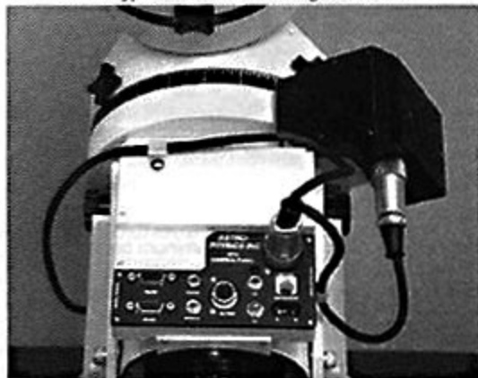
GTO Control Panel on 900GTO Mount
